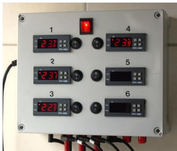
Le boîtier peut donc gérer jusqu'à 6 cuves de fermentation simultanément de façon indépendante. Sur cette photo, seuls les régulateurs 1 à 4 sont réellement connectés et sont donc actifs.
